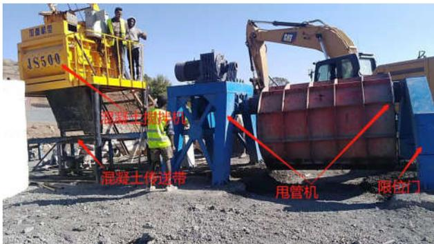
图1 制管设备布置图
