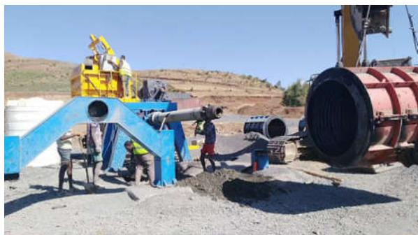
图3 旋转轴表面清理
