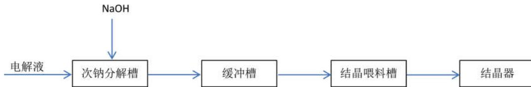
图1-2 酸性条件下结晶的基本流程
