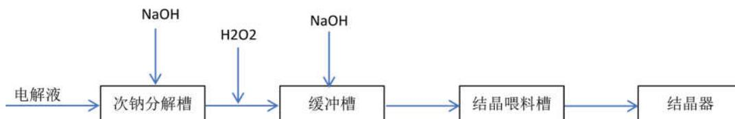
图1-1 碱性条件下结晶的基本流程
