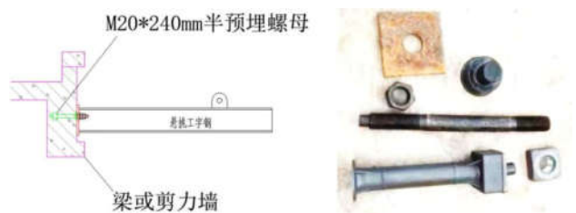
图1 半预埋螺母安装示意图
