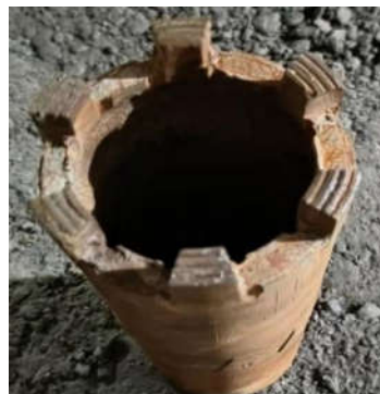
图2 人为减少工作面的环齿钻头
