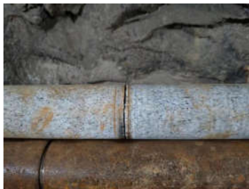
图1 采用烧钻头技术后出现的岩心磨头
