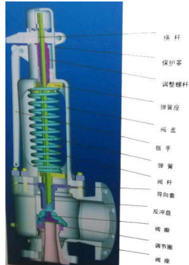
图3 安全阀剖面图
