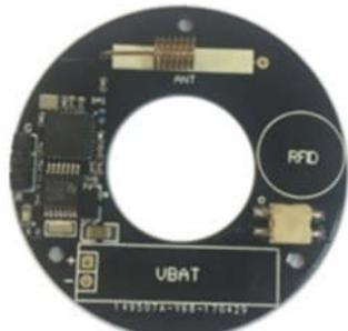
图3 LoRa震动传感器实物
