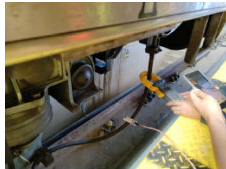
图4 车底回流线电流测试现场布置图
