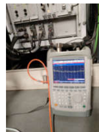
图3 BTM的电缆车上端口差模骚扰测试现场布置图 (车厢ATP机柜处)
