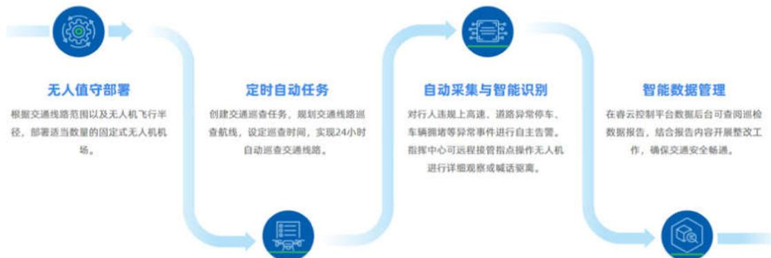
图五 无人机全自动巡检作业流程图
