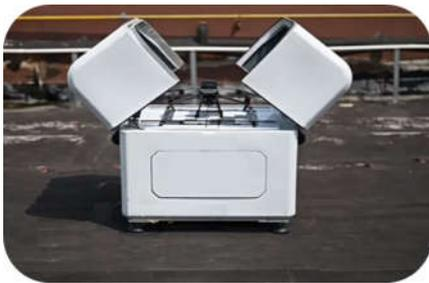
图二 无人飞行器自动机场外观图
