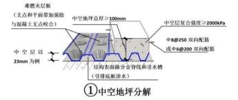
这是一种新兴的技术,它通过在建筑物的地坪和底部铺设一层中空的滤水板来实现滤水的效果。这种中空塑料滤水板主要是在塑料膜材料上制作,经过精细的压制,形成了一个封闭的凸起外壳,展示出了半球形、柱状等多样化的设计。这样的塑料虑水板设计提供了立体的空间以及一定的坚固度,使得液态和气态物质能够在其突起构造出的流动通道中更加自由地移动。假设底板有渗水,水就会通过由这些排水板提供的凸起支持而形成的排水区域流向集水池,然后再进一步排放到户外。
