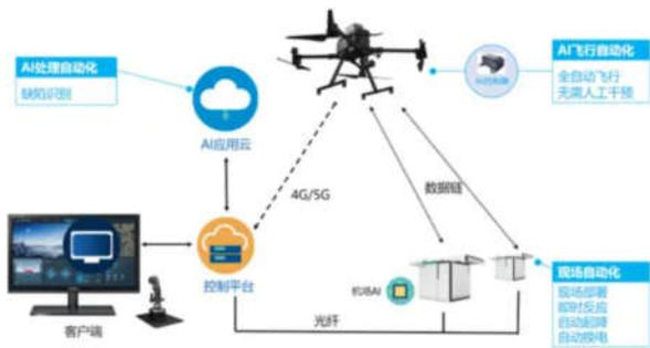
图2 无人机水利现场巡检系统示意图
