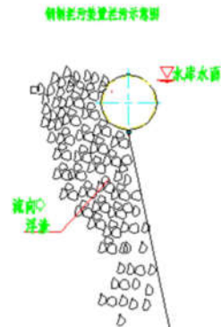
图3 钢制拦污装置拦污示意图
