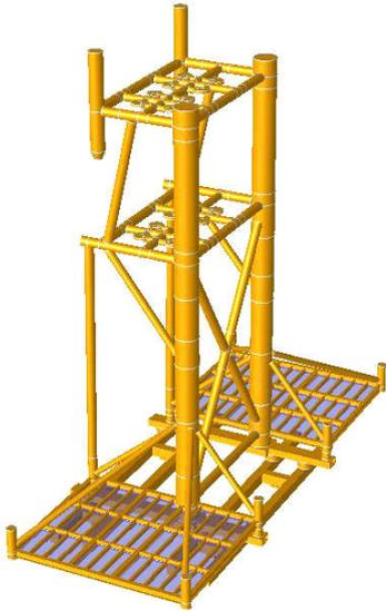
图1 两腿导管架结构形式
