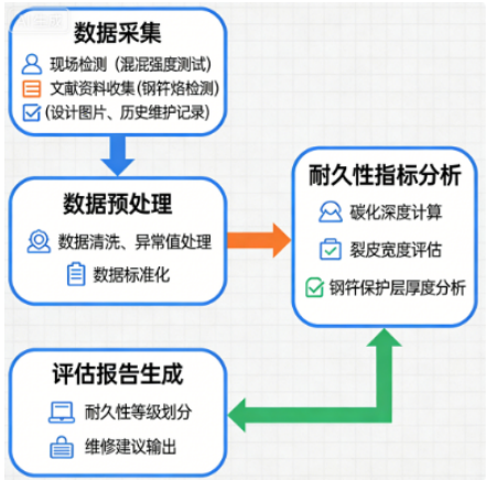
图 2-1 既有建筑结构耐久性评估数据流程示意图
