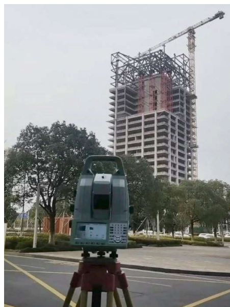
图3 智能测量机器人
