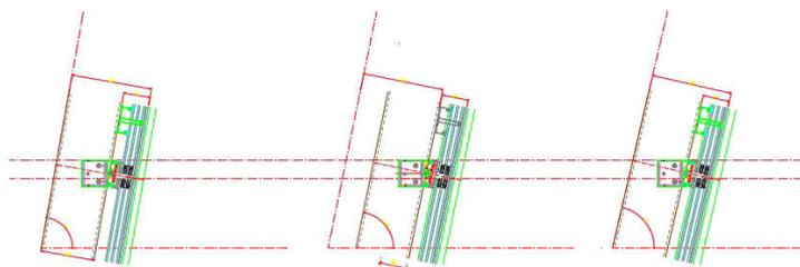
锥体1层80度玻璃幕墙节点竖 锥体1层78.5度玻璃幕墙节点竖 锥体1层77度玻璃幕墙节点竖
