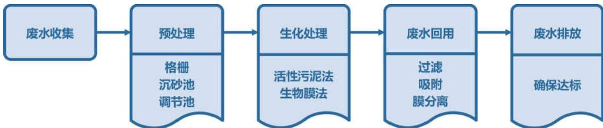
图1 废水处理与回用流程图
