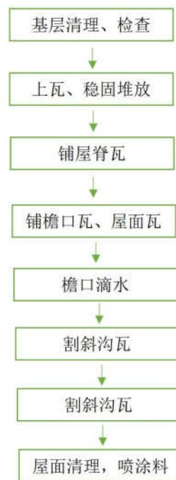
图2 施工流程图
