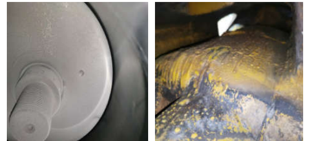
图3 3级气缸活塞表面 图4 3级缸进气流道锈蚀
