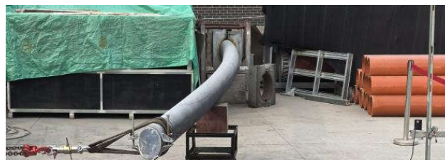
图2 各级荷载加载阶段梢经的挠度
