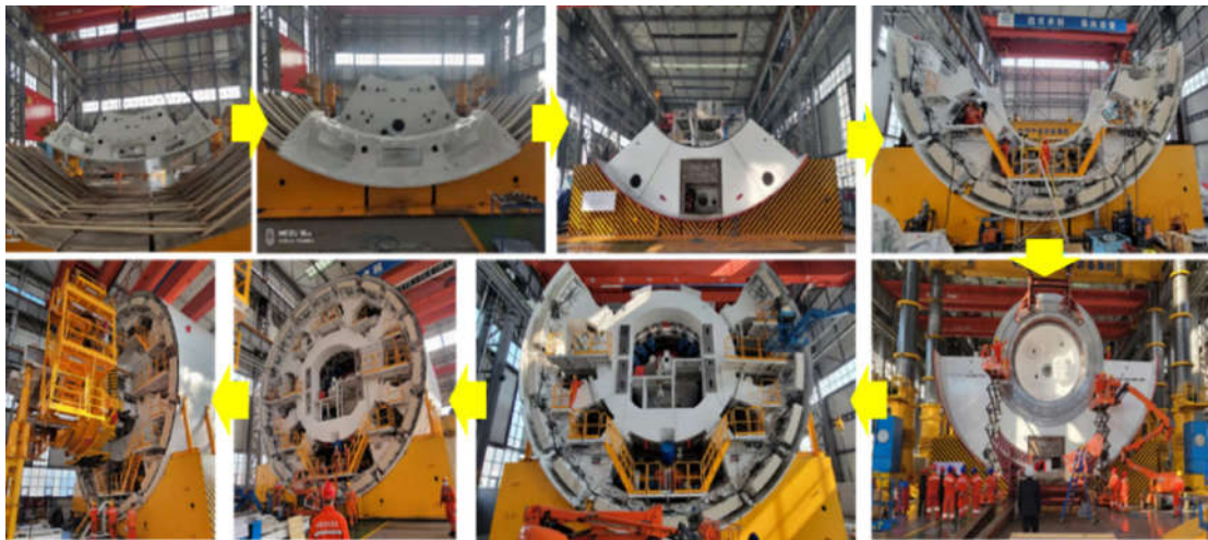
图4 盾体吊装组装流程
