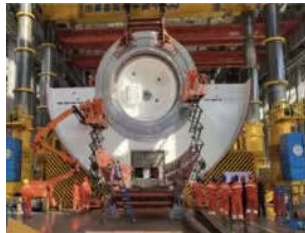
图3 主驱动吊至盾体上方
