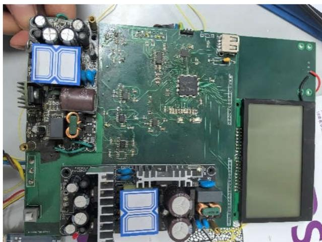
图4 电源测试模块实物图
