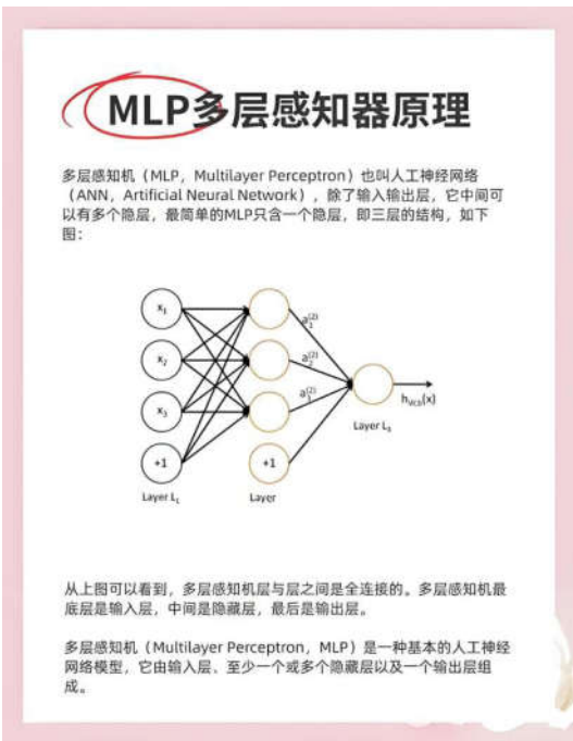
图1 MLP多层感知器原理架构图
