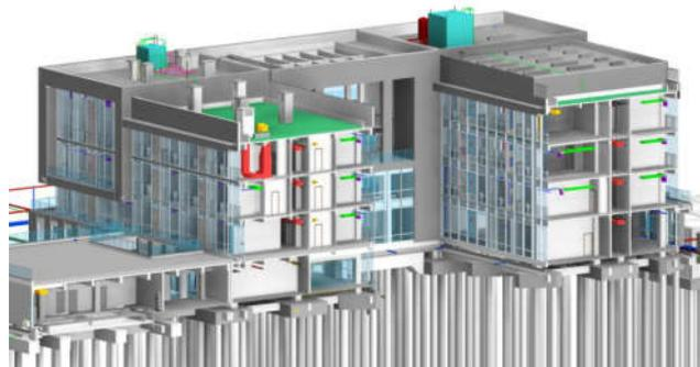
图3 建筑结构与设备专业管综合图
