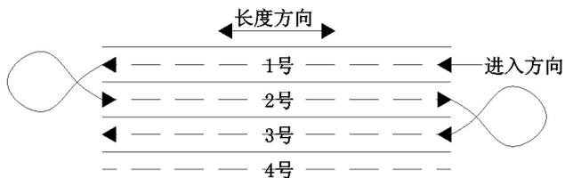
图2-2 冲击碾压行驶路线图(二)
