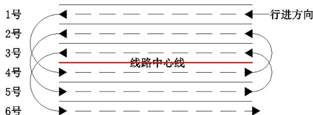
图2-1 冲击碾压行驶路线图(一)
