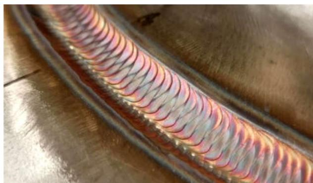
图4 焊接完成细节图
