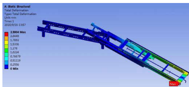
图4 担架支架翻转状态下的仿真位移云图
