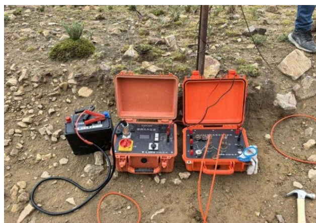
图1 高密度电法物探仪器
