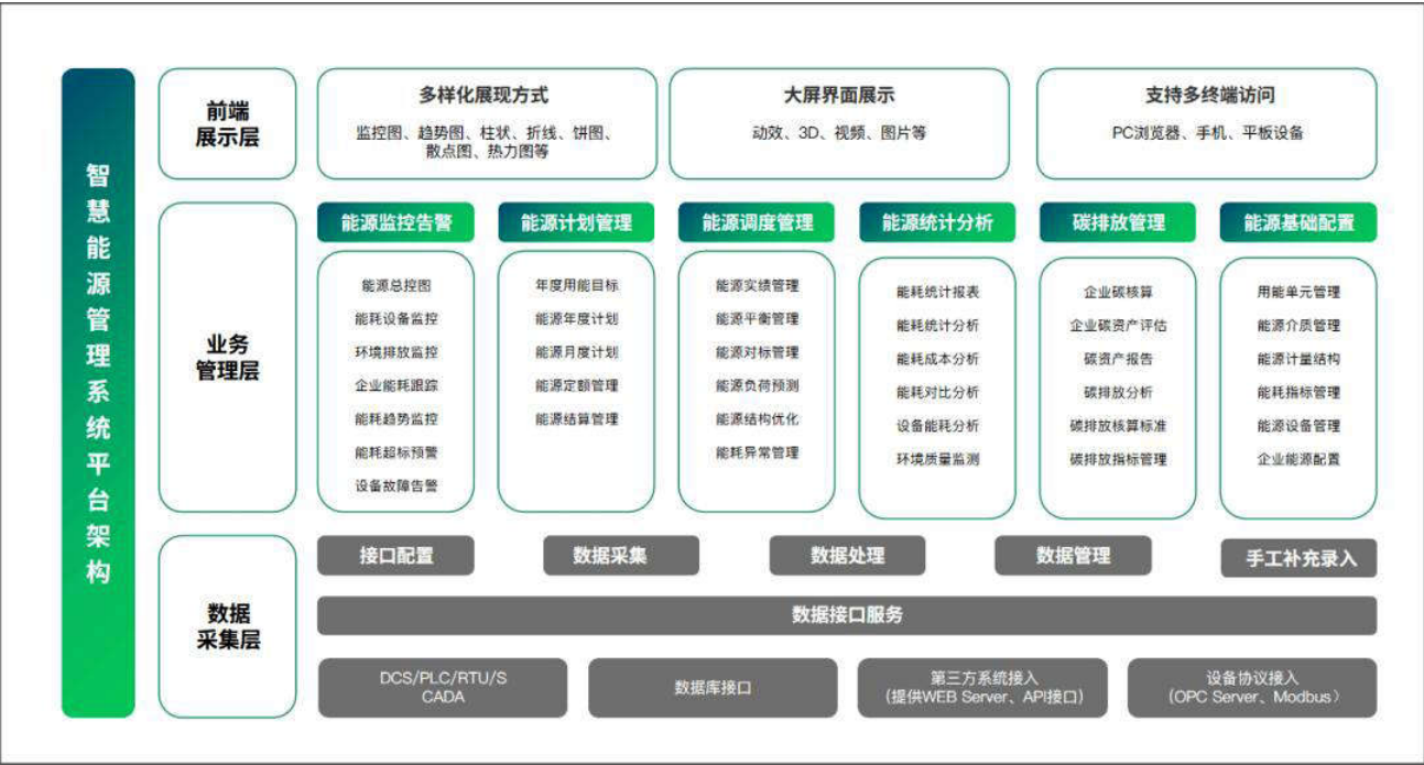
图1 智慧能源管理系统平台架构图示
