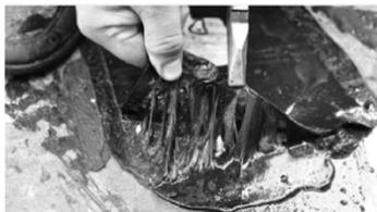
图2 DTSD防水材料粘性能
