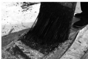
图1 DSTD防水材料弹塑性
