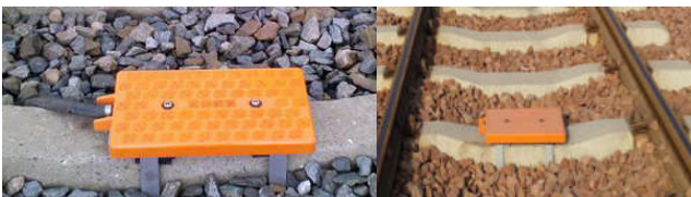
图9 应答器组上道安装示意图
