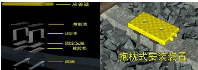
图10 应答器组上道安装示意图
