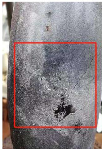
图5 冲刷裂纹
