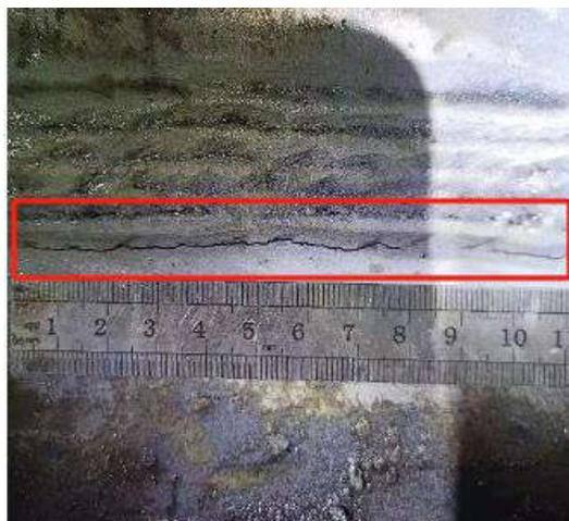
图6 应力腐蚀裂纹
