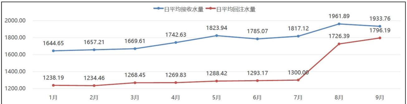
图5 气浮改造完成前后水处理能力变化曲线图
