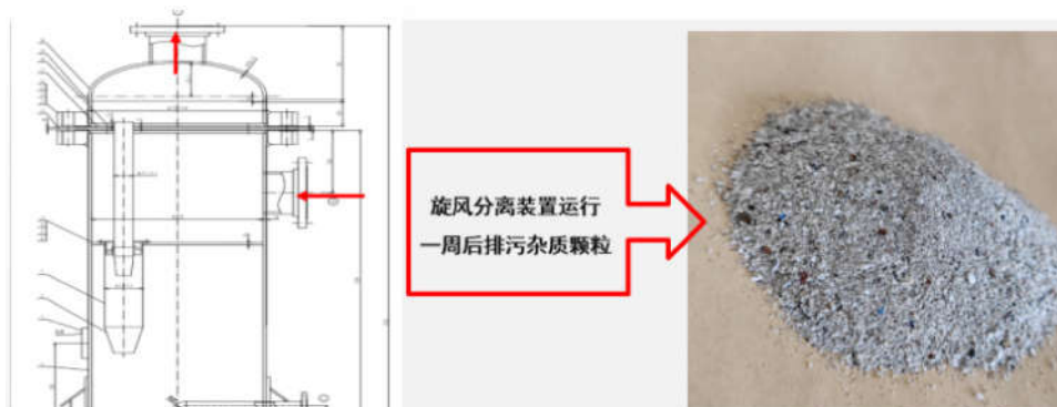
图03 冷冻水总管上增加了旋风分离器
