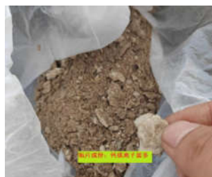
分布器内的垢片 图02 “冷冻水分布器清理的结垢”
