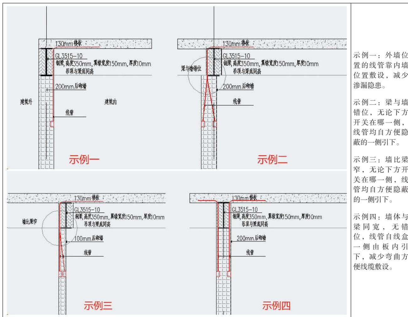
在如上几种情况,如果一次结构预埋在梁的另一侧,就会导致二次墙体配管时线管暴露在吊顶下无法隐蔽,因此必须在一次结构施工时就考虑二次墙体配管走向,并明确一次结构预埋时线管下来的位置;如有必要,在楼板内墙体两侧预留过线盒,以便穿线。
