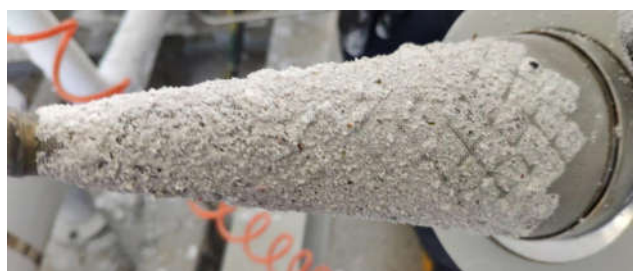
图3 LNG介质中珠光砂杂质
