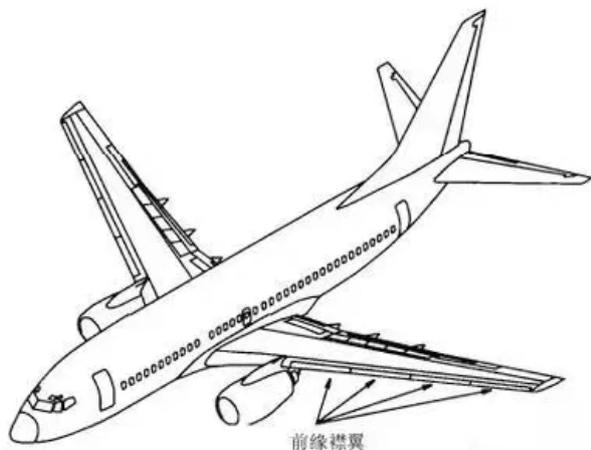
图1 飞机前缘襟翼图
