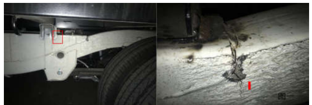
图1 车架开裂位置
