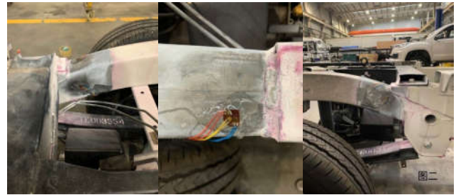
图2 应力采集传感器粘贴位置示意
