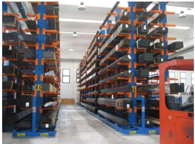
图3 材料和设备的存储框架
