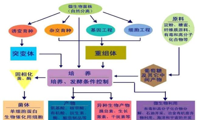
图2 发酵工程示意图
