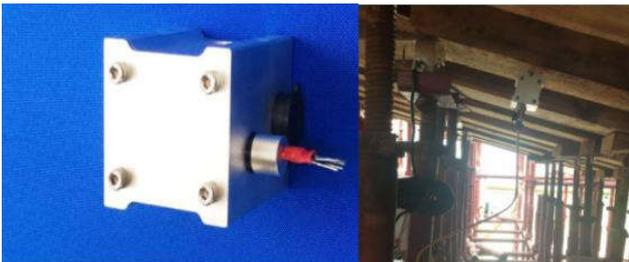
图4 高精度位移传感器
