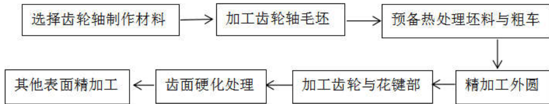
图3 齿轮轴的具体加工工艺顺序
