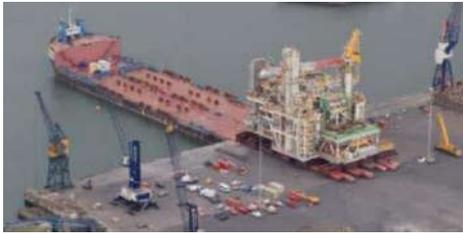
图6 海上升压站整体运输示意图
