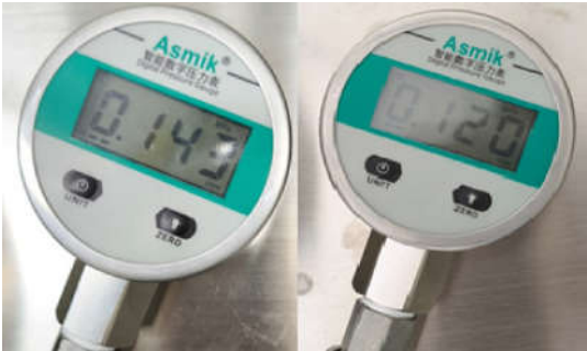
图3 气路气密性测试照片
