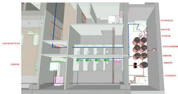
图2 空气能热泵热水系统透视图
