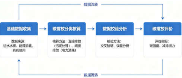
污水处理厂碳排放核算框架流程图1
