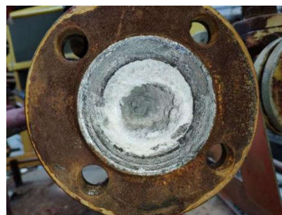
图5 干气至进料缓冲罐管线铵盐堵塞
