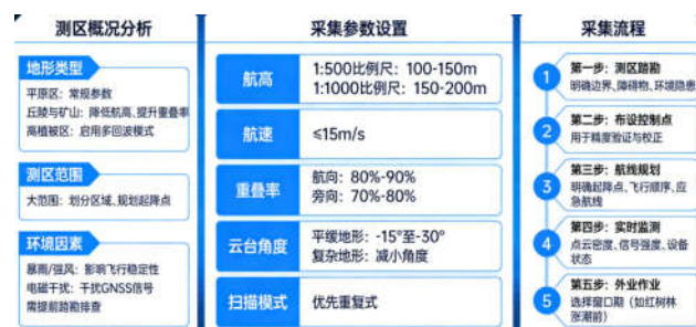
图1 无人机LiDAR采集参数与地形适配关系图
