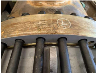
图1 螺栓预紧力不够,垫片挤出
