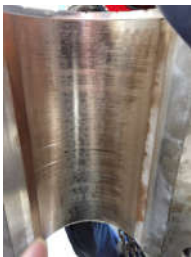
图4-2 对轮端径向瓦下瓦接触情况
