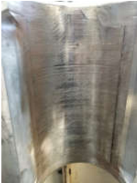
图4-3 非对轮端径向瓦下瓦接触情况
