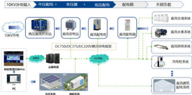
图1 绍兴植物园项目直流配电系统框架
